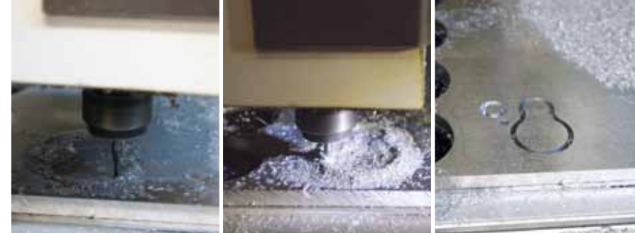
Mit viel Lärm arbeitet sich die Fräse durch das 6 Millimeter starke Aluminium
