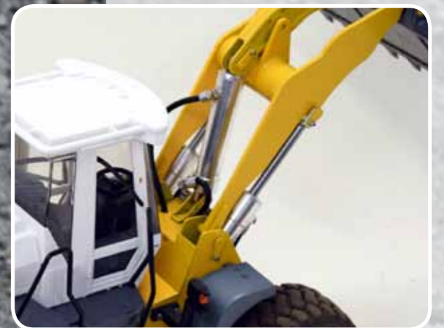
Bei der Hydraulik – Betriebsdruck etwa 12 Bar – werden bewährte Komponenten von Leimbach verwendet
