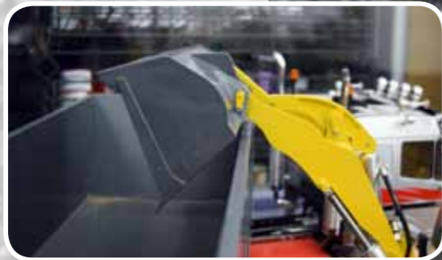
Die Kinematik ist so konstruiert, dass auch hohe Mulden noch gut beladen werden können
